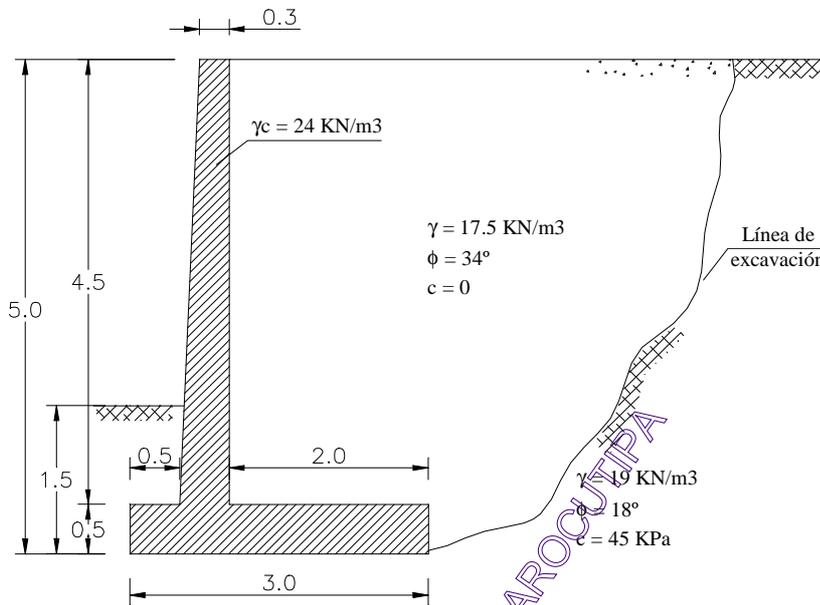
**Figura 11.8.** Características del muro y parámetros del suelo.
