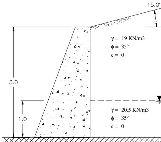
**Figura 11.2.** Dimesiones del muro.
