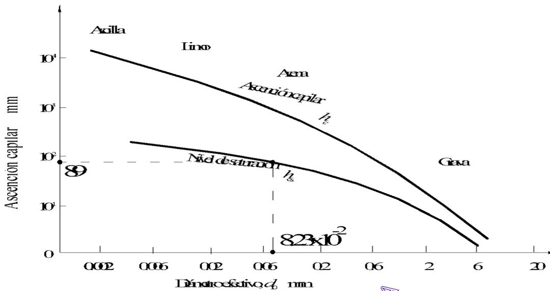
Figura 4.23. Determinación de la altura de suelo saturada de agua capilar.
