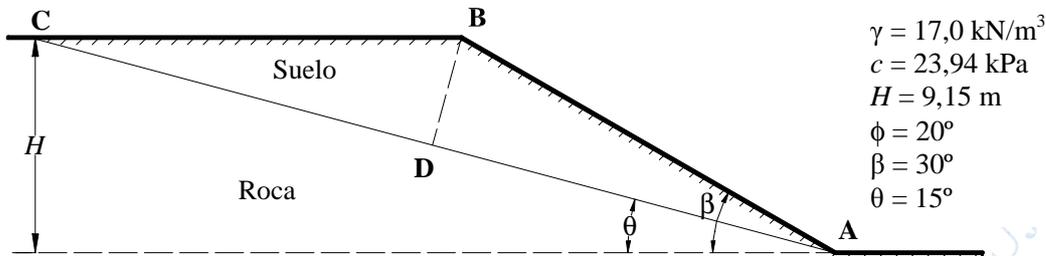
Figura 12.6. Dimensiones del talud.
