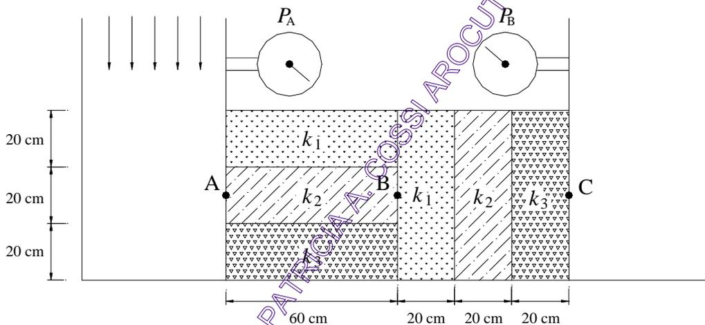
**Figura 4.38.** Permeámetro con dos arreglos suelo.
