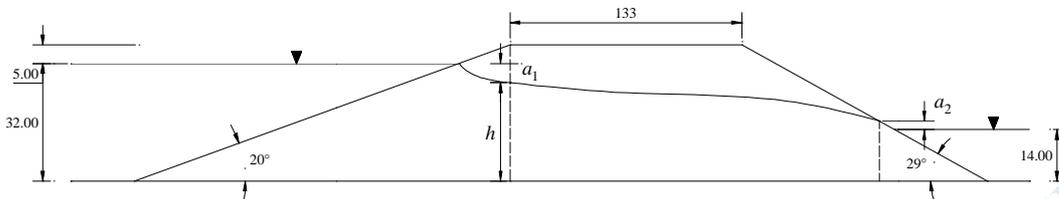
**Figura 4.90.** Presa de tierra con línea freática.
