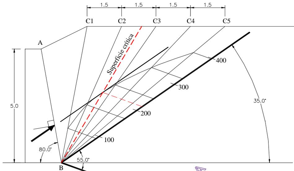
Figura 11.5. Determinación de la superficie crítica.
