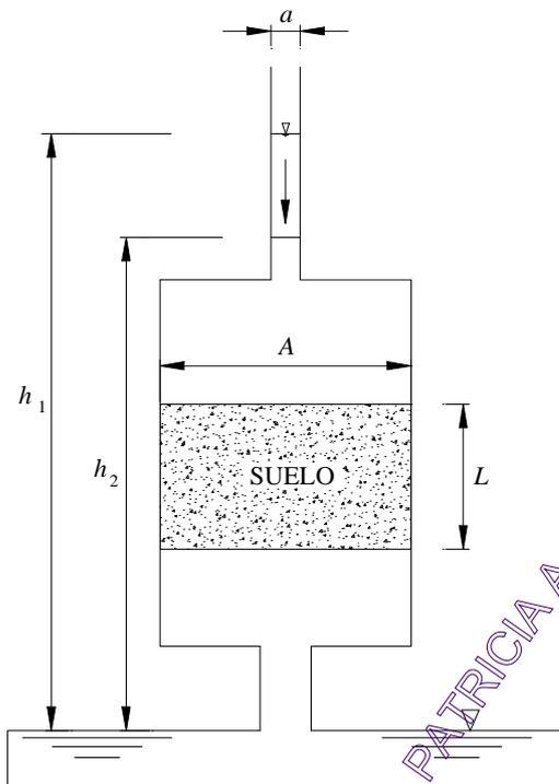
**Figura 4.26.** Permeámetro de carga variable.
