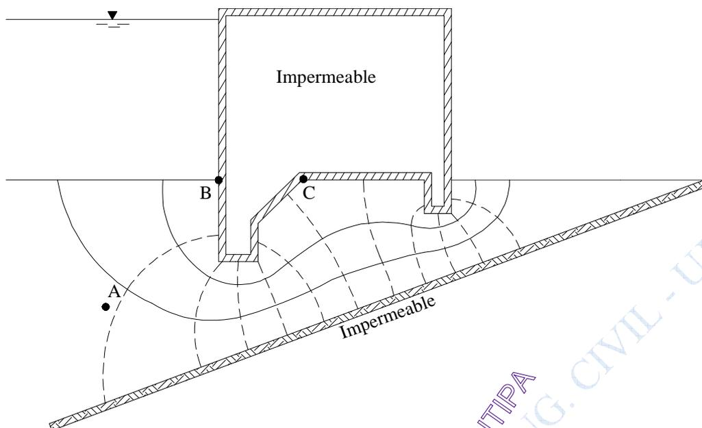
**Figura 4.50.** Puntos donde se pretende calcular la presión de poros.
