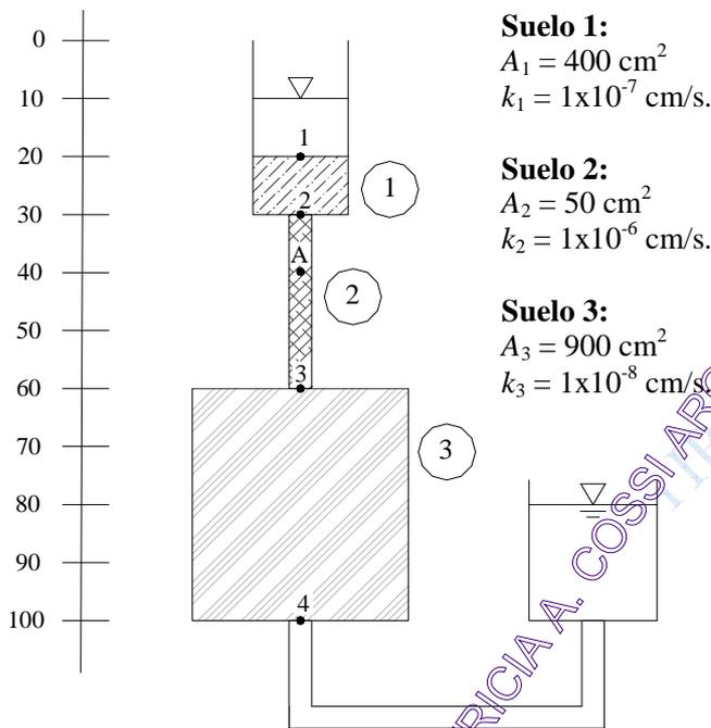
**Figura 4.27.** Permeámetro con tres capas de suelo.
