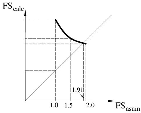
Figura 72.21. Determinación del factor de seguridad.
