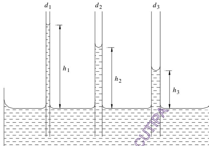
Figura 4.21. Ascenso capilar máximo en tubos de diámetro variado.
