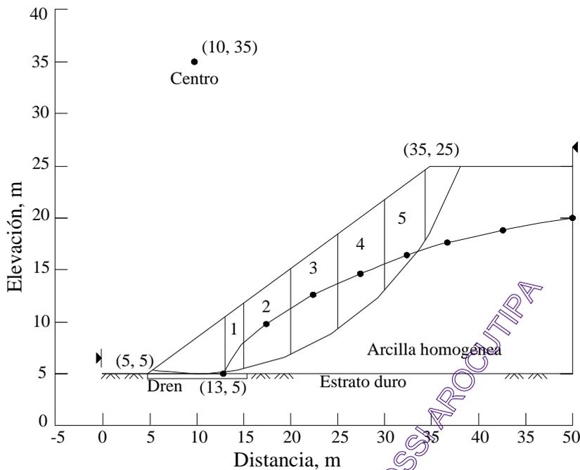
Figura 22.16. Talud dividido en fragmentos.
