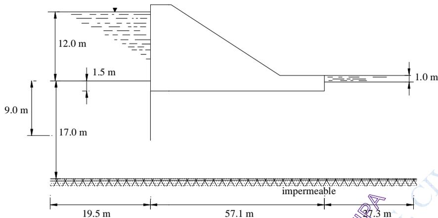
**Figura 4.54.** Sistema de flujo en una presa de concreto con afaguía.
