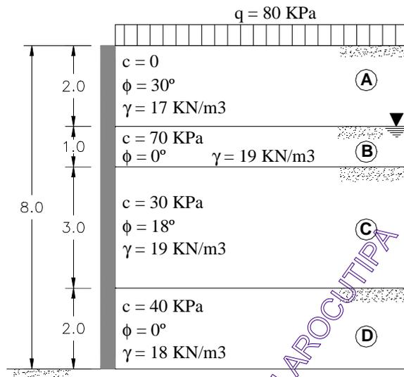
Figura 11.6. Características de los estratos de suelo y el muro.
