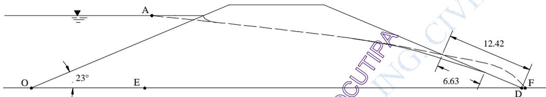
Figura 4.64. Correcciones en los bordes de entrada y salida.
