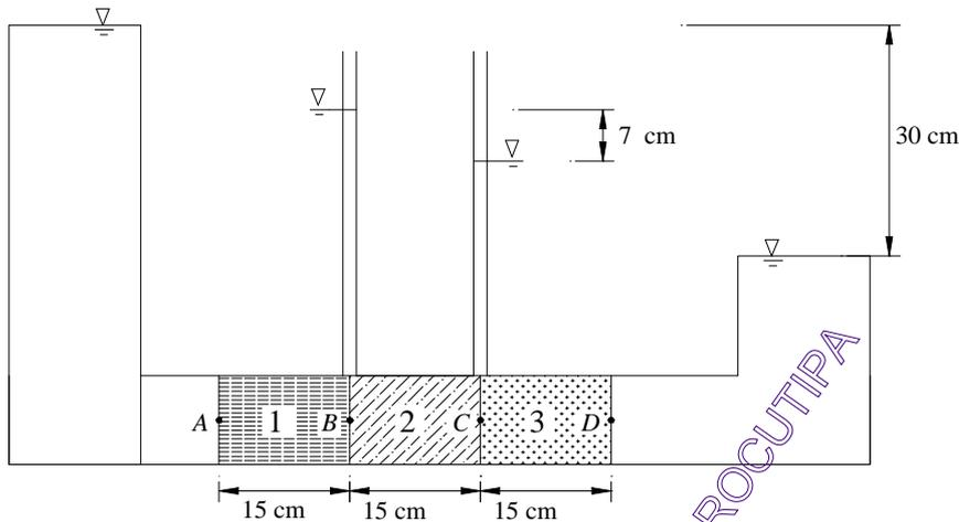
**Figura 4.39.** Permeámetro con tres capas de suelo
