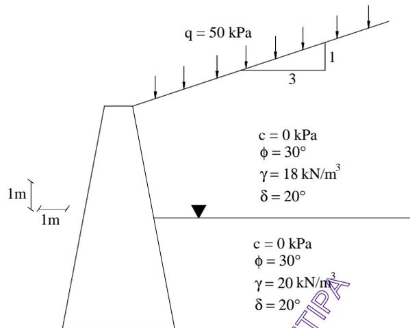
**Figura 11.16.** Características del muro de contención.
