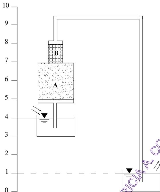
**Figura 4.27.** Permeámetro con dos capas de suelo.
