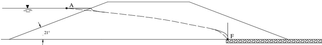
Figura 4.69. Correcciones en los bordes de entrada y salida.
