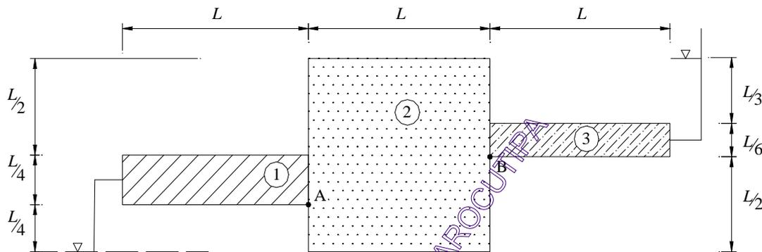
**Figura 4.40.** Permeámetro con tres capas de suelo a diferentes alturas.
