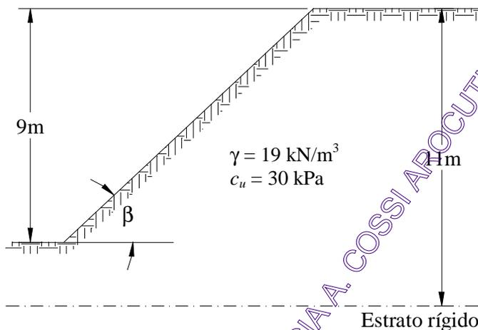
Figura 12.2. Dimensiones del talud.
