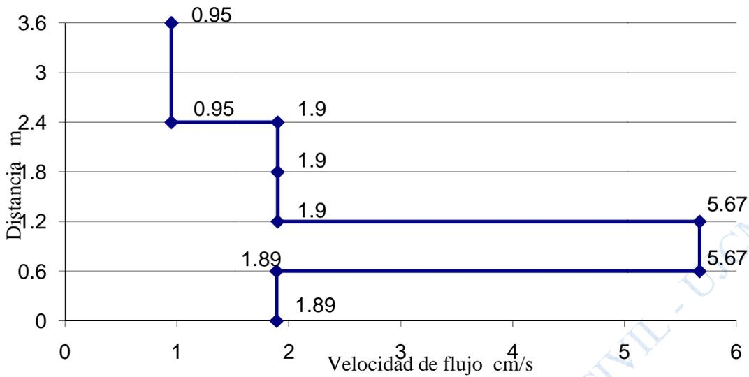
**Figura 4.31.** Variación de la velocidad de flujo con la profundidad.
