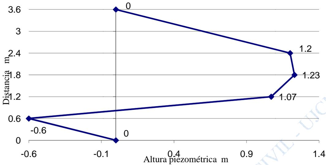
Figura 4.30. Variación de la altura piezométrica con la profundidad.
