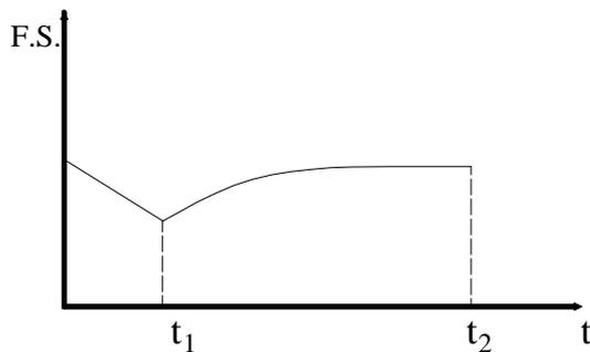
Figura 12.14. Variación del factor de seguridad.
