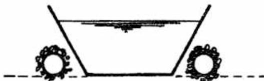
FIG.4.2 Disposición tubería de drenaje
