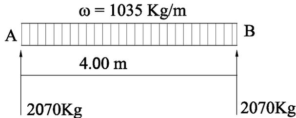
La reacción de 2070 Kg en el extremo *B*, deflexiona a la viga flexible *CD*, generalmente un  $\Delta$ .
