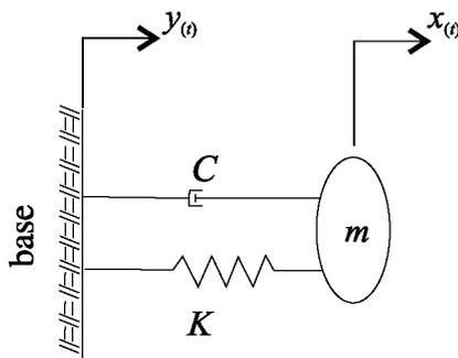
A esta relación entre la cimentación y el sistema se denomina transmisibilidad. Sea  $y_{(t)} = y_0 \text{ Sen } \omega t$  el movimiento de la base, calcularemos la fuerza que se transmite a la masa así como la amplitud de la vibración de la masa.
