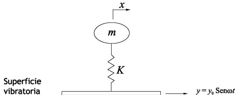
que el instrumento se encuentre montado rígidamente sobre la superficie significa que la masa tiene el desplazamiento de la base.
