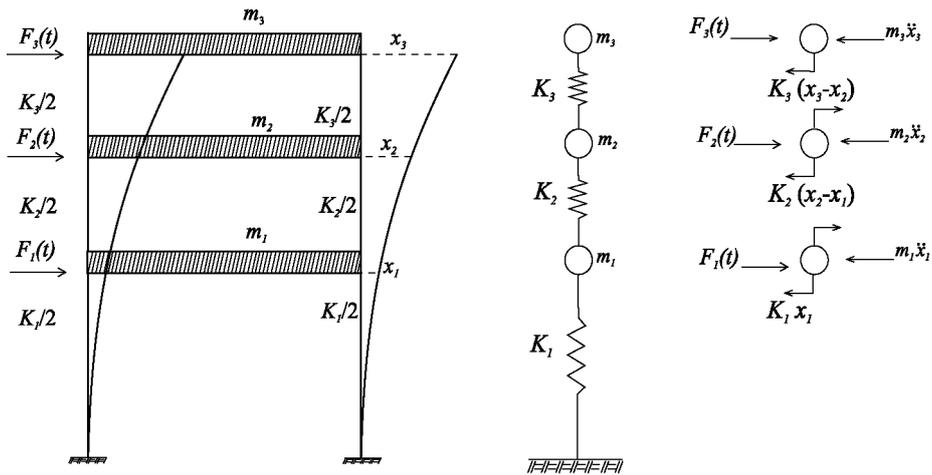
$$\begin{bmatrix} m_1 & 0 & 0 \\ 0 & m_2 & 0 \\ 0 & 0 & m_3 \end{bmatrix} \begin{bmatrix} \ddot{x}_1 \\ \ddot{x}_2 \\ \ddot{x}_3 \end{bmatrix} + \begin{bmatrix} K_1 + K_2 & -K_2 & 0 \\ -K_2 & K_2 + K_3 & -K_3 \\ 0 & -K_3 & K_3 \end{bmatrix} \begin{bmatrix} x_1 \\ x_2 \\ x_3 \end{bmatrix} = \begin{bmatrix} F_1(t) \\ F_2(t) \\ F_3(t) \end{bmatrix}$$
