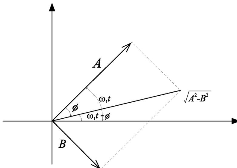
$$A \text{Sen } \omega t + B \text{Cos } \omega t = \sqrt{A^2 + B^2} \text{Sen}(\omega t - \phi)$$
