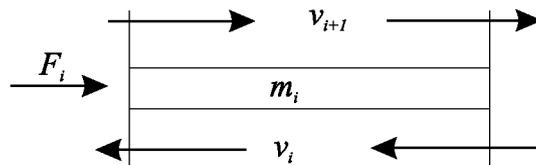
donde las fuerzas que actúan sobre la masa  $m_i$  serán  $F_i$  y las cortantes que le transmiten las columnas superiores e inferiores que vienen dados por:
