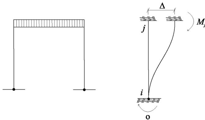
$$M_{ij} = M_{ij}^o + 2 \frac{EI}{h} (2\theta_i + \theta_j - 3\psi_{ij}) \dots\dots(a)$$
