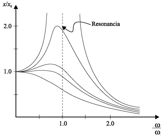
Si el amortiguamiento es pequeño, la máxima amplitud tiene lugar muy cerca de  $\omega/\omega_1 = 1$ , por lo que la máxima amplitud puede muy próximamente ser establecida para  $\omega/\omega_1 = 1$  teniendo así:
