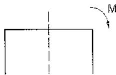
**f) Momento Grande y Carga Axial Despreciable:** el elemento se comportara como una viga.
