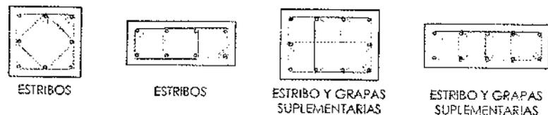
Figura 1.1 Ejemplos de configuraciones de los estribos de confinamiento para columnas.
