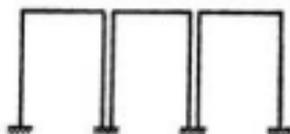
FIG. 11.19. Serie de pórticos simples equivalentes a un pórtico de edificio.
