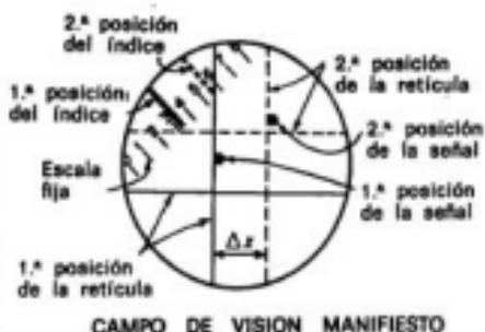
FIG. 19.2. Campo del microscopio micrométrico.
