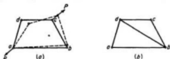
FIG. 4.1. Entramados: (a) no rígido; (b) rígido.
