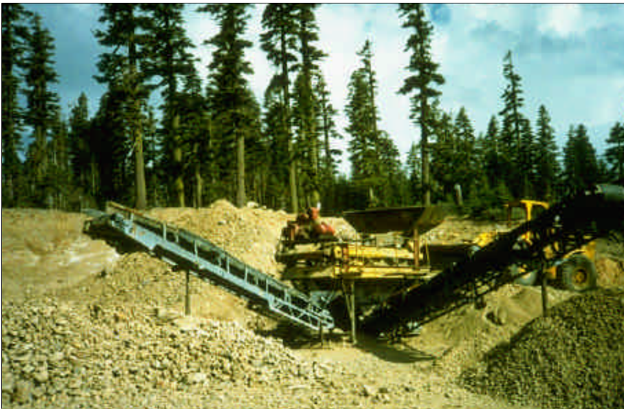
Foto 12.10 Las pedreras y bancos de préstamo pueden proporcionar un recurso excelente y relativamente barato como fuente de materiales para el proyecto. Un sitio de explotación puede sólo necesitar una excavación simple, cribado o triturado, para producir los materiales necesarios. Controle el uso de la zona con un Plan de Desarrollo de Bancos.
