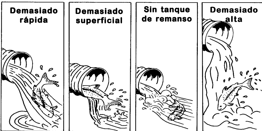
Figura 2.2b Alcantarillas mal diseñadas o instaladas, con “barreras para peces” que evitan el paso de peces. (Redibujado de Evans and Johnston, 1980. )
