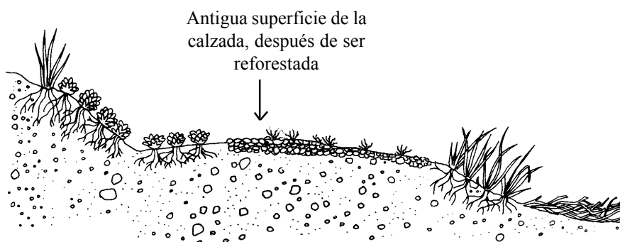
c. Puesta fuera de servicio - Cierre permanente del camino mediante escarificación de la superficie y siembra de semillas para reforestación, pero manteniendo la mayor parte de la plantilla del camino. (geometría).
