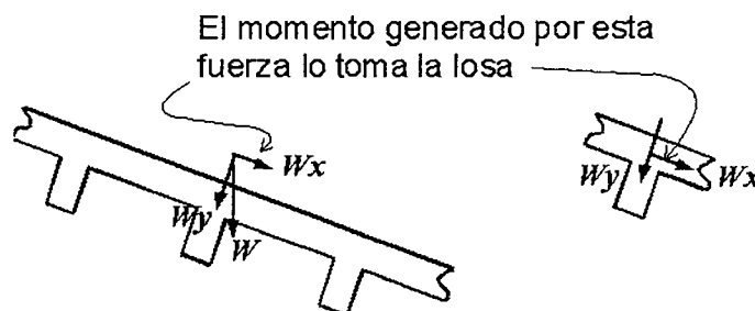
Fig. 18-3 Losa o techo inclinado.
