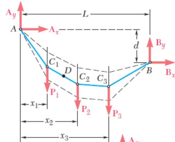
De esta manera, se debe obtener una ecuación adicional considerando el equilibrio de una porción del cable, dibujando el DCL del segmento AD del cable y escribiendo una ecuación de momento en D y luego se pueden determinar las reacciones en A y B.
