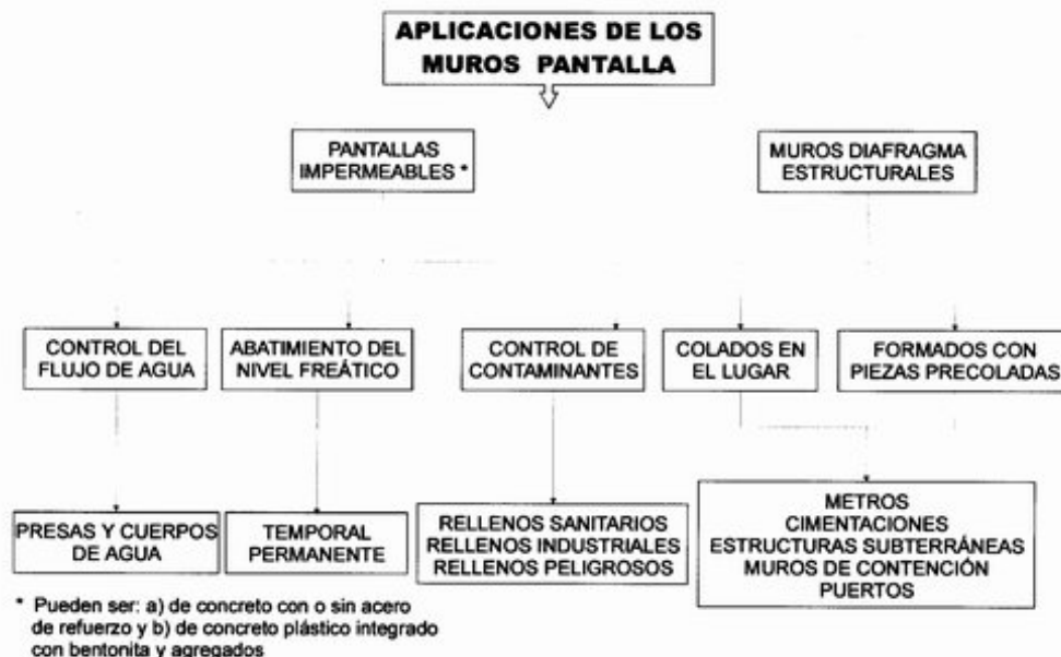
Fig. 3.1, Campos de aplicación de los muros diafragma
