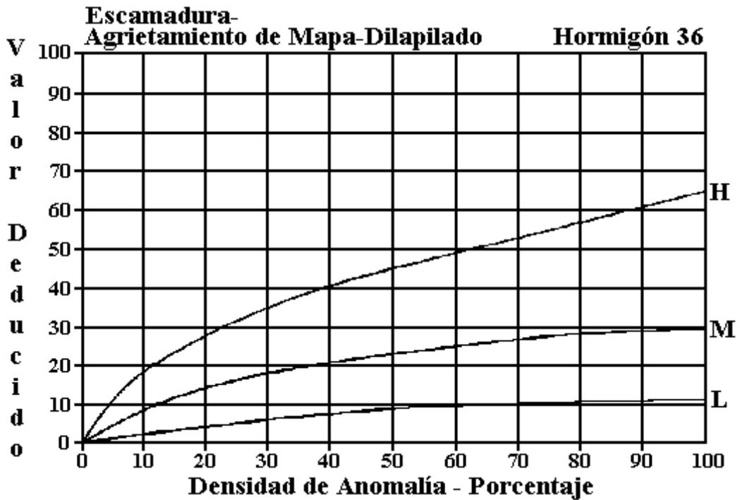
Figura C-35. Escamadura / Agrietamiento de Mapa / Dilapidado.
