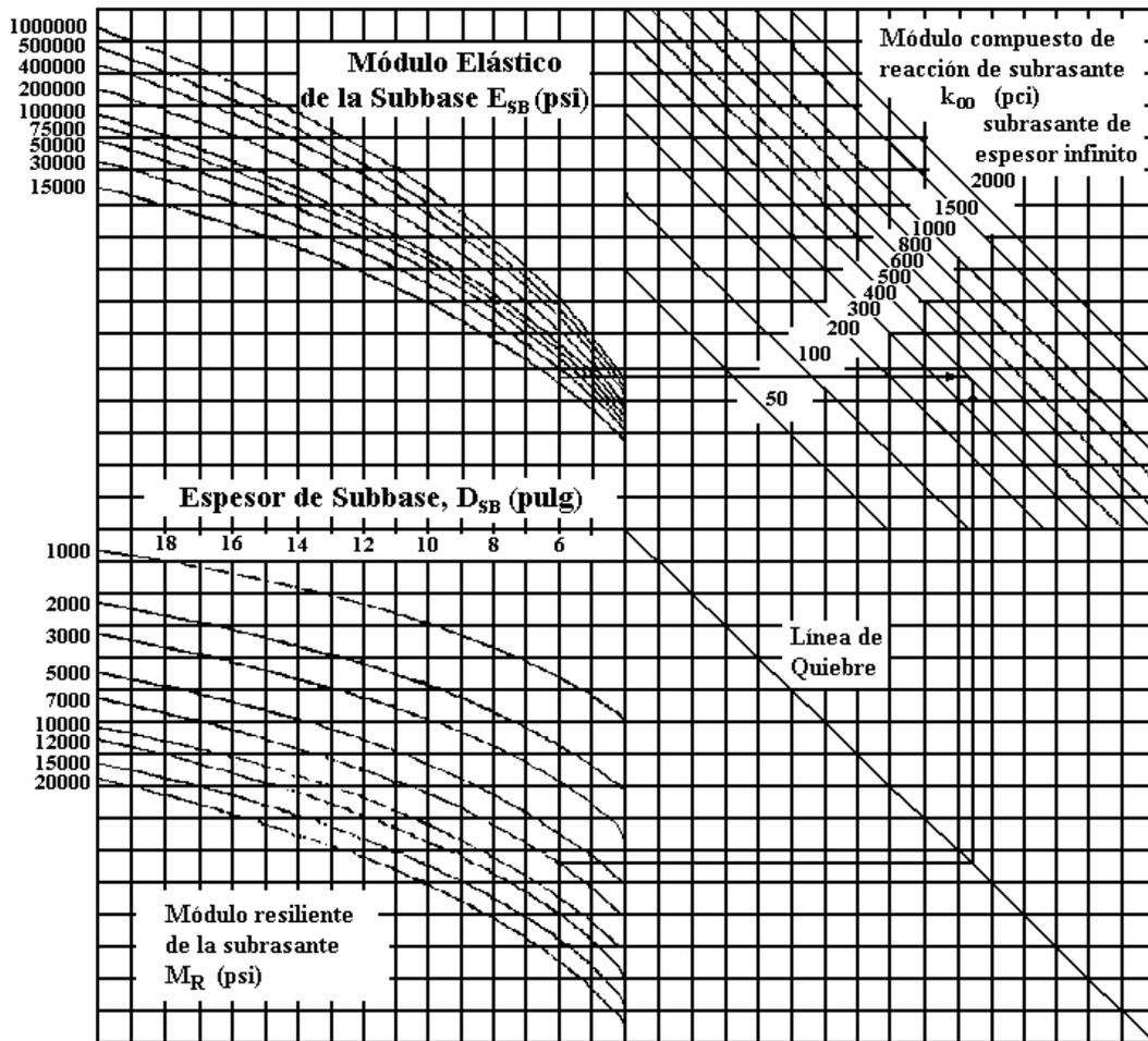
**Figura VIII.1.** Ábaco para obtener el Módulo de reacción compuesto por efecto combinado de subrasante y sub-base (para espesor infinito de bajo la subrasante).
