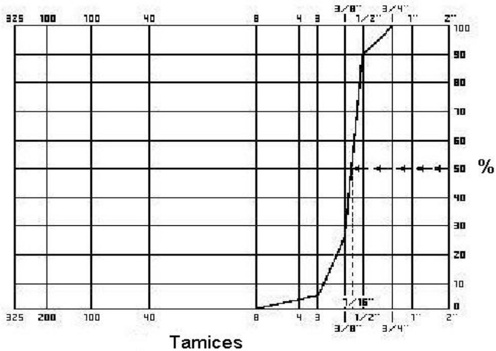
**Figura III.2.** Curva Granulométrica del Agregado
