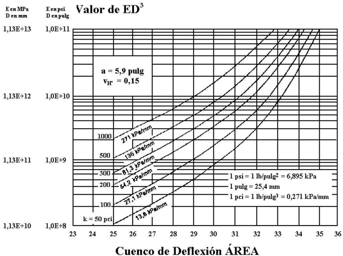
**Figura XI.9.** Módulo elástico del hormigón en función de  $k$  y ÁREA.
