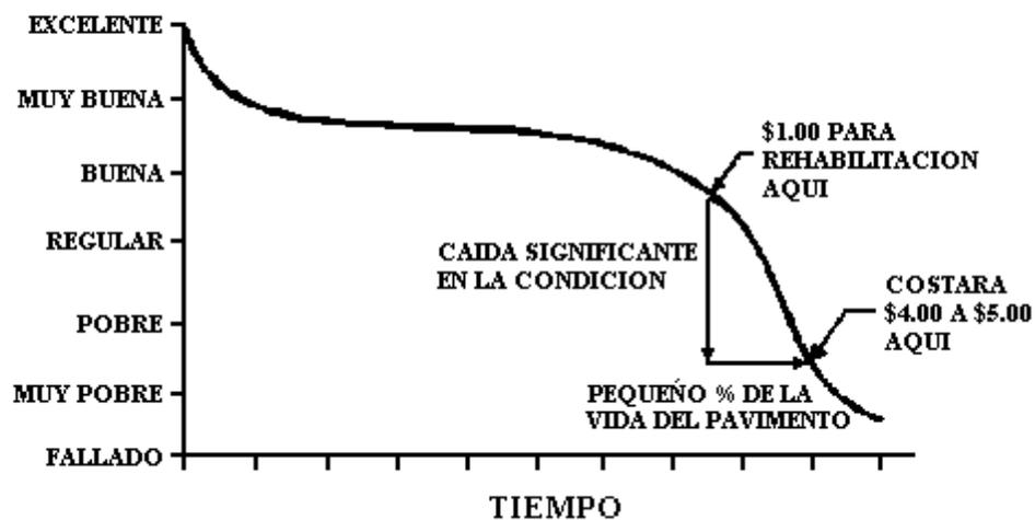
**Figura X.1.** Ilustración Conceptual del Ciclo de Vida de la Condición del Pavimento
