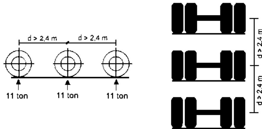
También pueden encontrarse ejes triples conformados por la combinación de un eje tandem y un eje simple. En los cuales la distancia entre los ejes tandem es menor a 2,4 metros, y la distancia al eje simple es mayor a 2.4 metros. (11 Ton. para el eje simple y 18 Ton. para el eje tandem).
