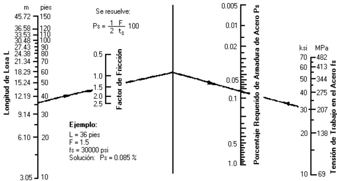
**Figura VIII.5.** Ábaco de diseño para pavimentos de hormigón armado con juntas.
