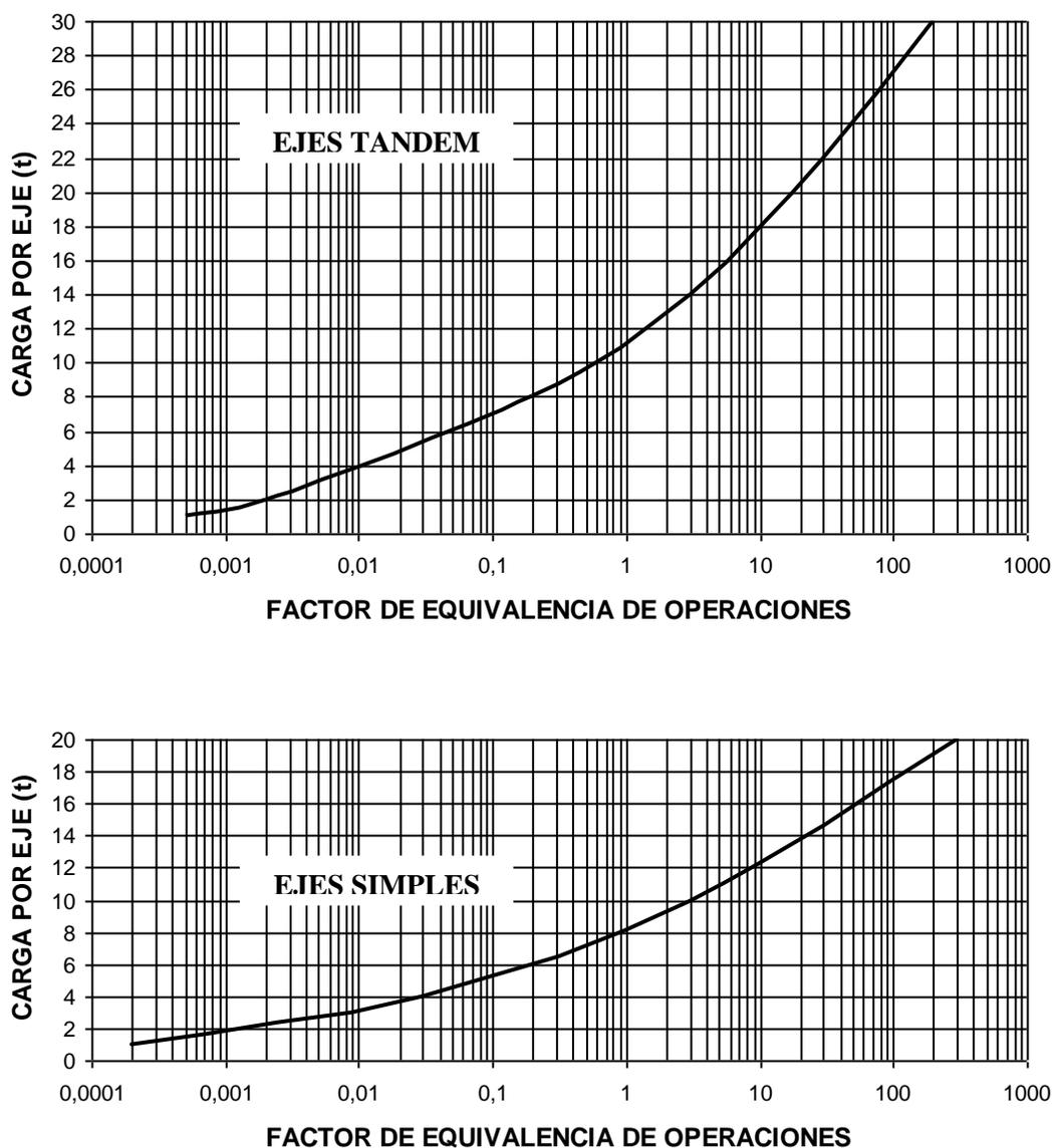
**Figura V.1.** Factores de equivalencia de operación ( $FC_j$ ) para ejes simples y tandem, con diferentes cargas, en relación a un eje simple patrón de 18000 lb (8,2 t).
