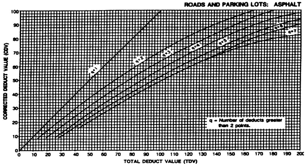
**Figura X.9.** Curvas de Corrección para Pavimentos de Caminos de Concreto Asfáltico.
