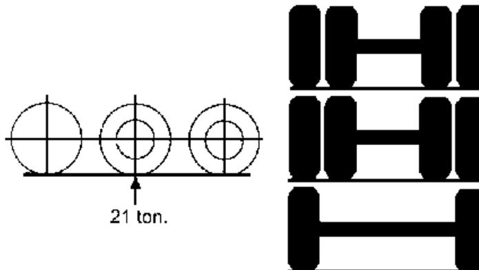
Peso máximo admisible para un eje tridem de 12 neumáticos es de 25000 Kg (55 Kips).
