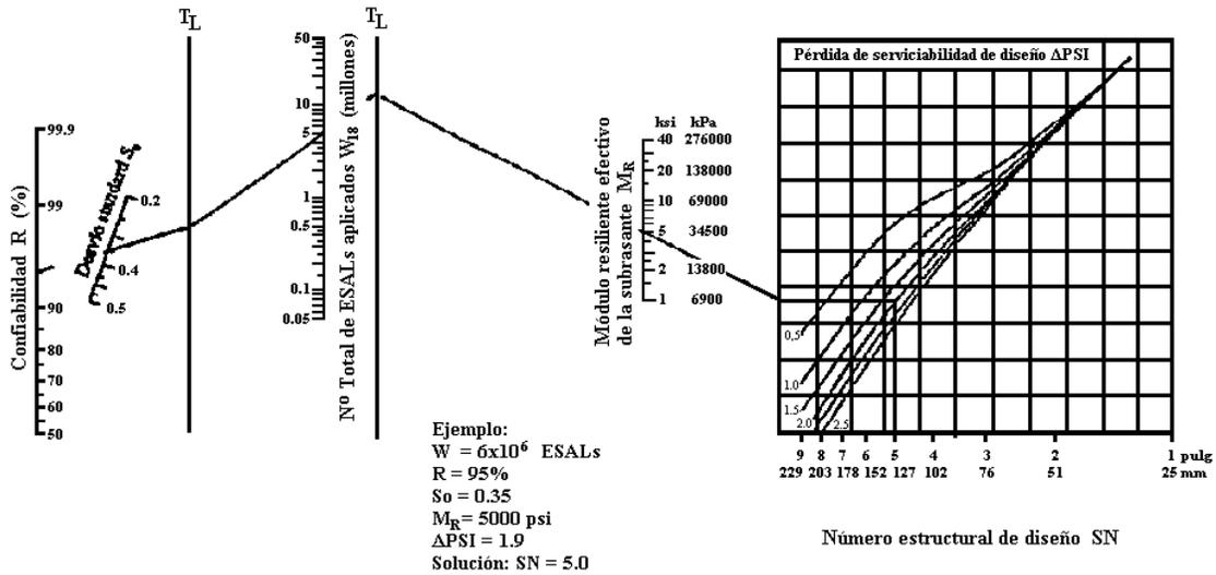
**Figura IV.2.** Ábaco de diseño AASHTO para pavimentos flexibles.
