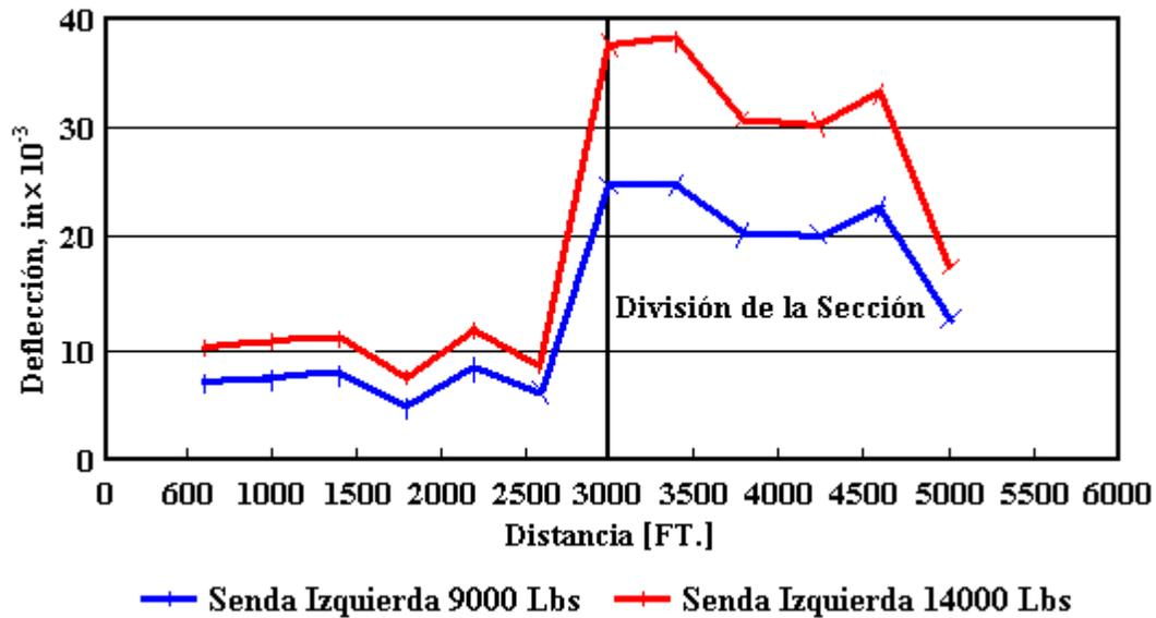
**Figura X.2.** Ejemplo del uso del ensayo no-destruccion de deflexión (NDT) para definir las secciones del pavimento.
