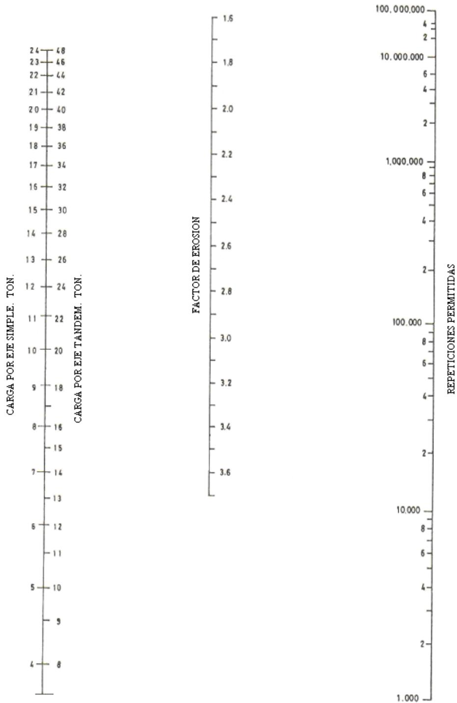
**Figura IX.4.** Método PCA 1984, análisis por erosión - acotamiento pavimentado.
