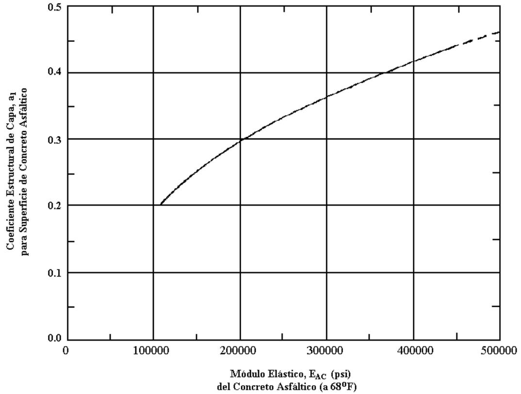
**Figura IV.3.** Ábaco para estimar el número estructural de la carpeta asfáltica “ $a_1$ ”.
