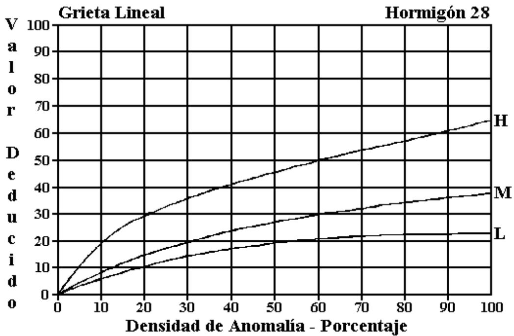
Figura C-27. Agrietamiento Lineal.
