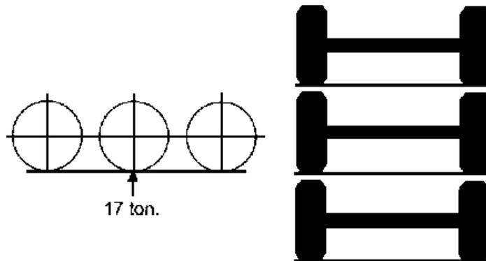
Peso máximo admisible para un eje tridem de 10 neumáticos es de 21000 Kg (46 Kips).
