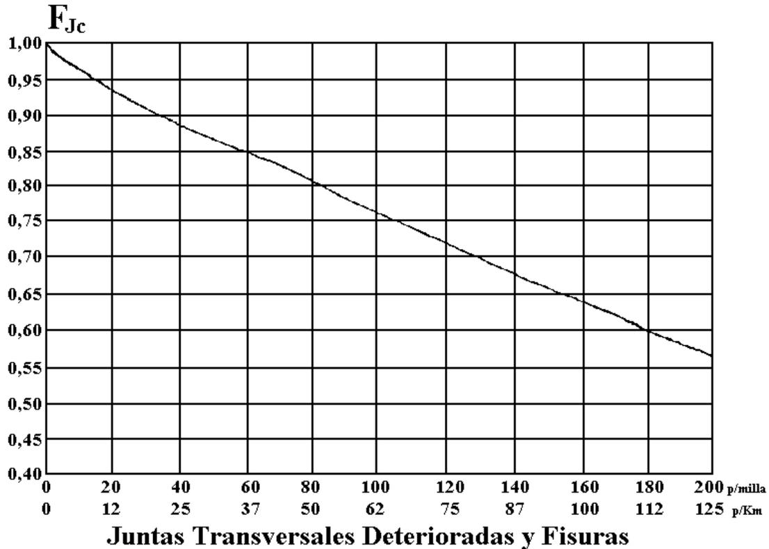
**Figura XI.10.** Factor de ajuste por juntas y fisuras.
