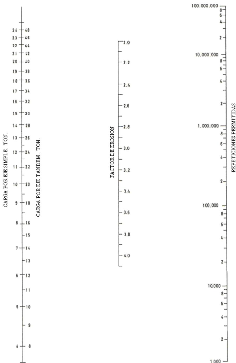
**Figura IX.3.** Método PCA 1984, análisis por erosión - acotamiento sin pavimento.
