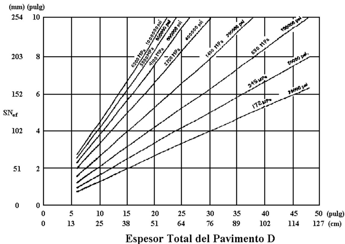
**Figura XI.6.**  $SN_{ef}$  en función de  $E_p$  (Método NDT)
