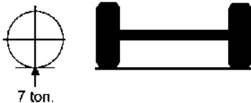
Peso máximo admisible para un eje simple de 4 neumáticos es de 11000 Kg (24 Kips).
