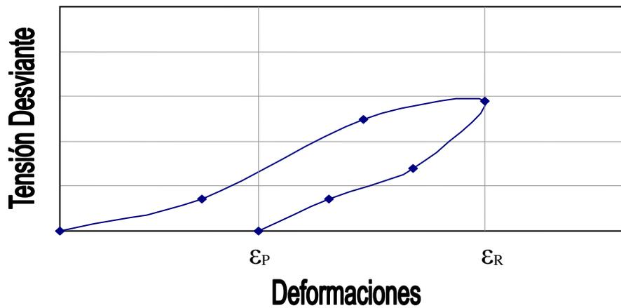
**Figura I.4.** Relación entre deformación vertical y carga desviante.
