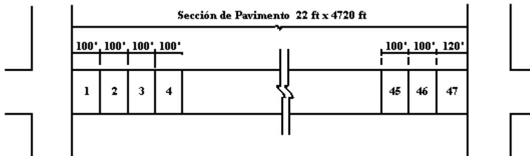
**Figura X.5.** Ejemplo de una sección de pavimento dividida en unidades de prueba.
