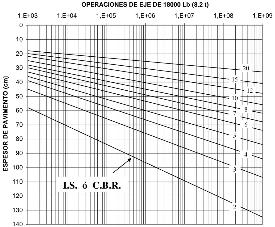
**Figura V.2.** Espesor de pavimento, en función de ( $N$ ) y el *I.S.* (o el *C.B.R.*).
