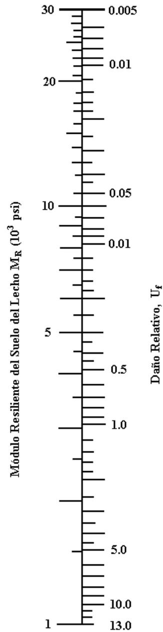
**Figura IV.1.** Ábaco para la determinación del Daño Relativo
