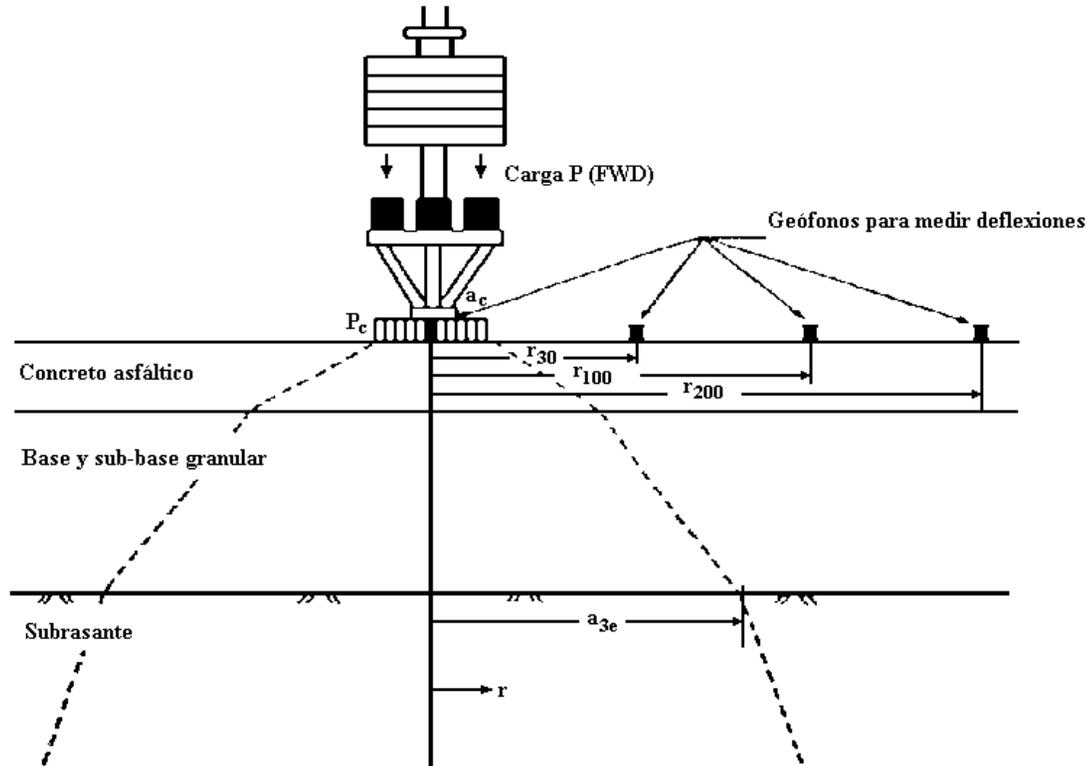
**Figura XI.1.** Esquema de la zona sometida a tensiones en un pavimento sometido a un ensayo FWD.
