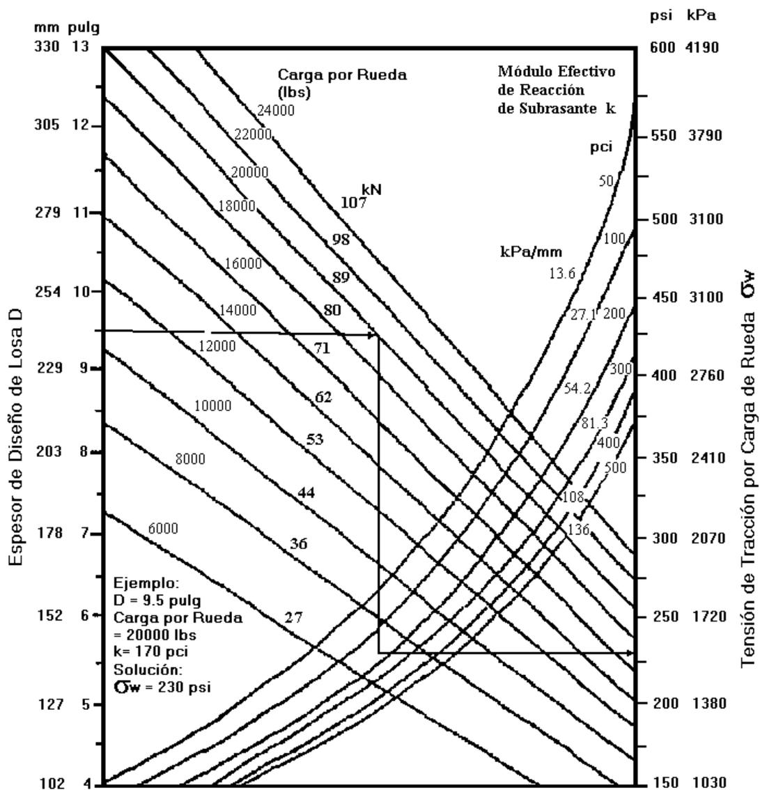
**Figura VIII.6.** Ábaco para estimar las tensiones de tracción debidas a carga de ruedas.
