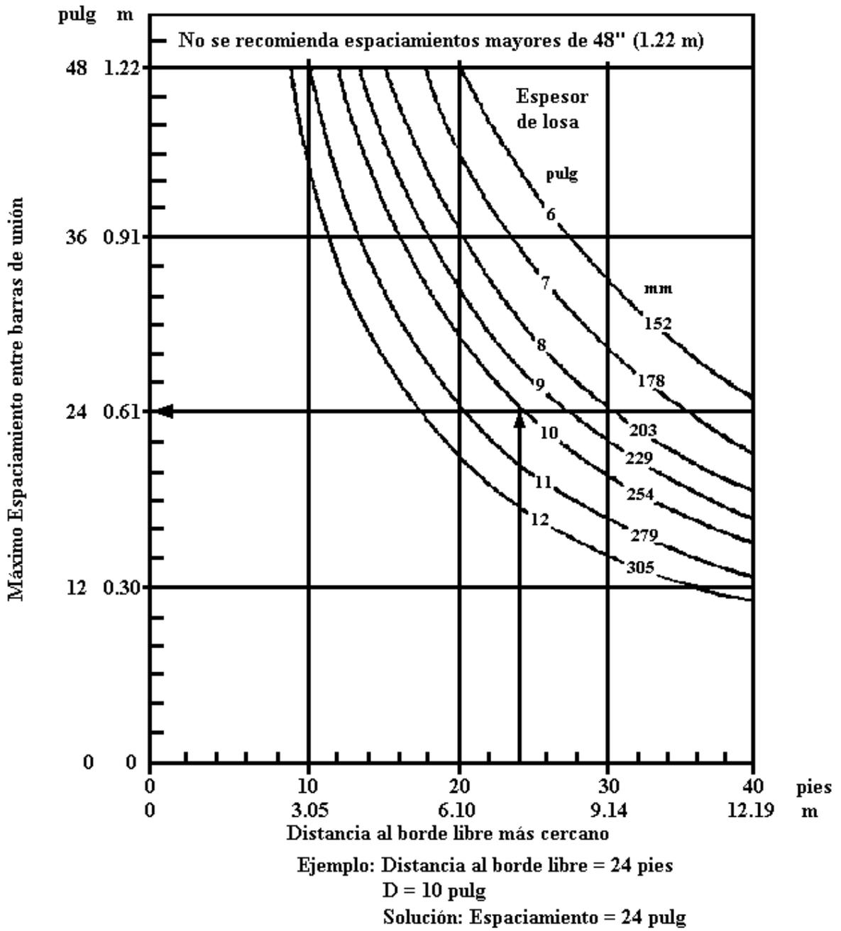
**Figura VIII.11.** Espaciamiento máximo recomendado para barras de unión de 16 mm en pavimentos de hormigón simple. Acero Grado 40.
