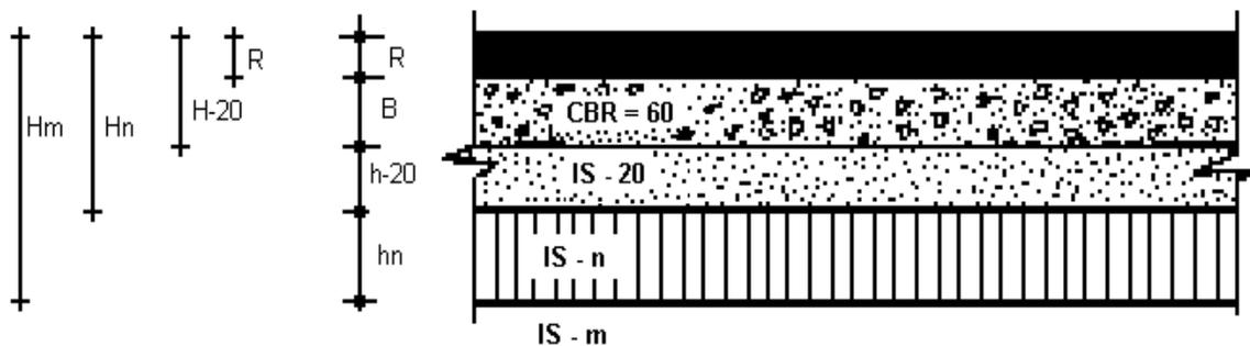
**Figura V.3.** Simbología utilizada en el dimensionamiento del pavimento
