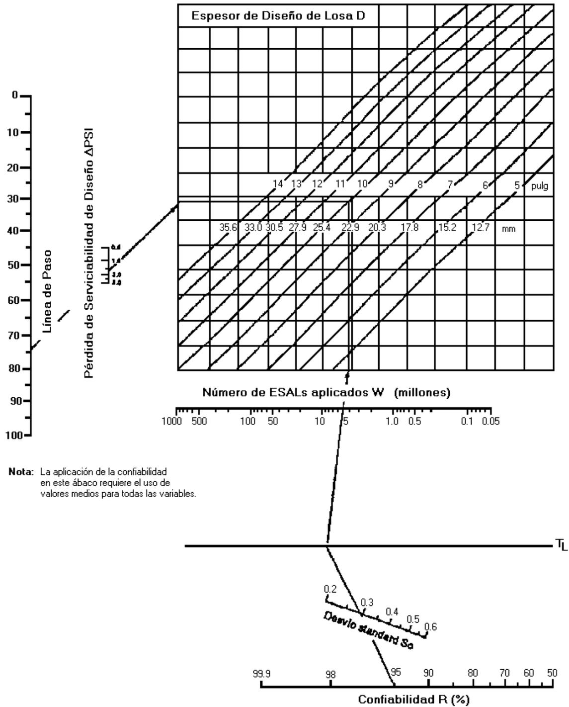
**Figura VIII.4.b.** Ábaco de diseño para pavimentos rígidos.
