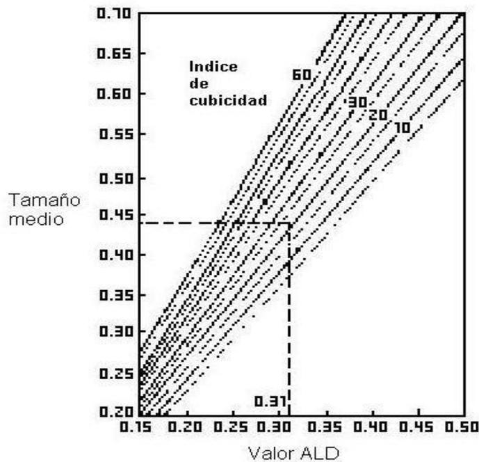
**Figura III.3.** Valor del Tamaño Máximo Efectivo (ALD), en Pulgadas.
