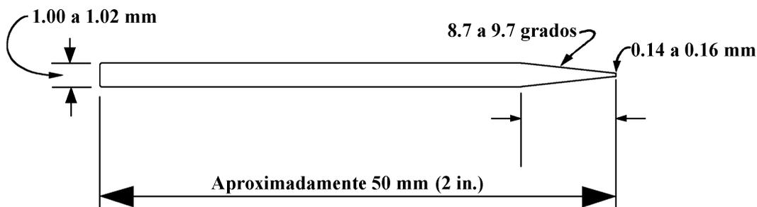
FIGURA 1. Aguja para el Ensayo de Penetración
