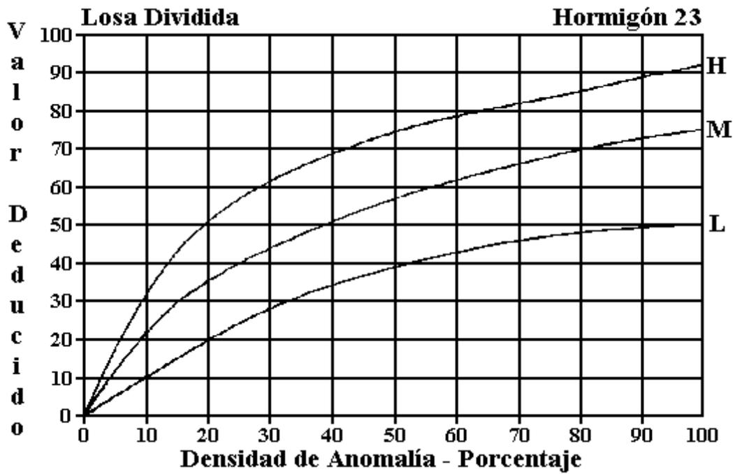
Figura C-22. Losa Dividida.
