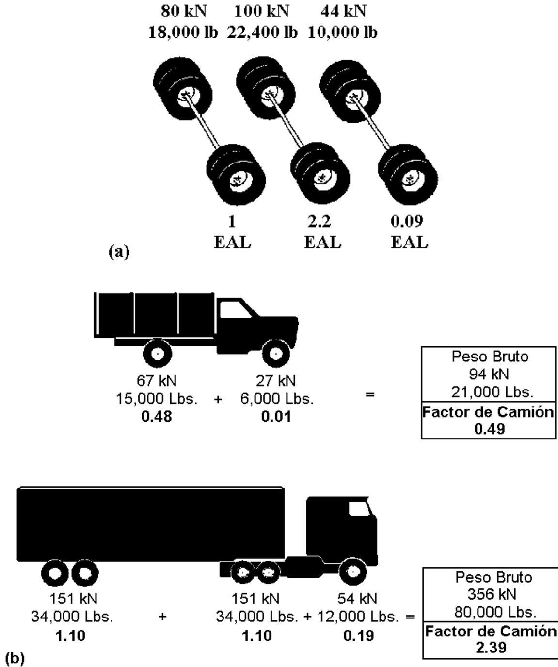
**Figura VI.4.** Factores de Equivalencia de Carga.
