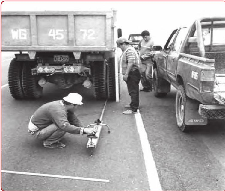
**Foto 7.1** Medición de deflexiones con Viga Benkelman
