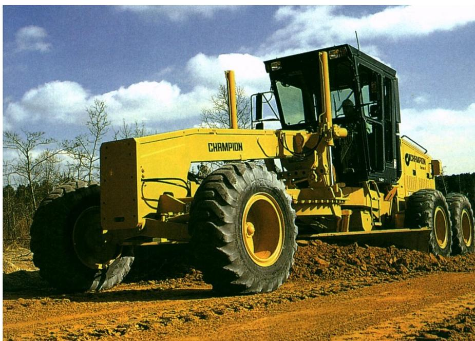
Fig. 16.7 – Motoniveladora perfilando la explanada mejorada
