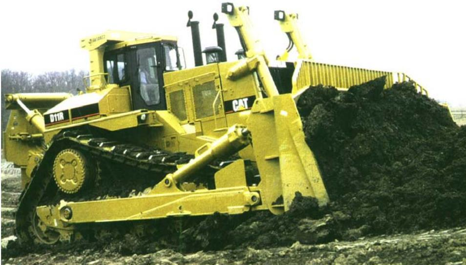
Fig. 16.3 – Bulldozer efectuando labores de excavación y escarificado
