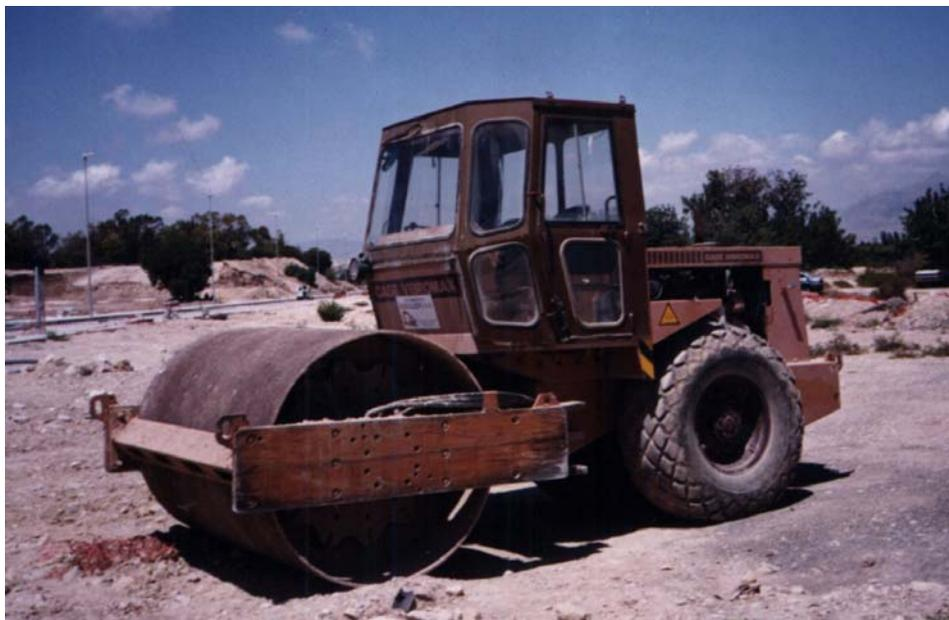
Fig. 22.9 – Compactador vibratorio empleado en capas granulares
