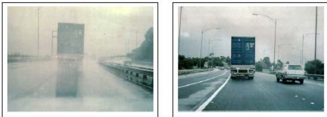
Figura 3.15. - Diferencia de visibilidad en un instante de lluvia cuando se circula sobre una superficie densa y sobre una superficie drenante
