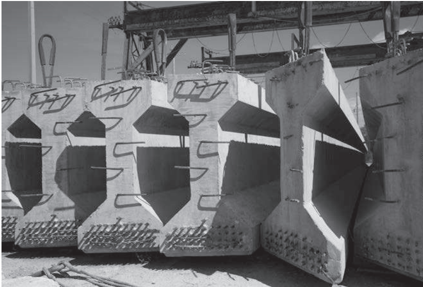
Trabes presforzadas precoladas de puente de carretera en una planta de producción en la Florida central. (© Ron Buskirk/Alamy Limited.)
