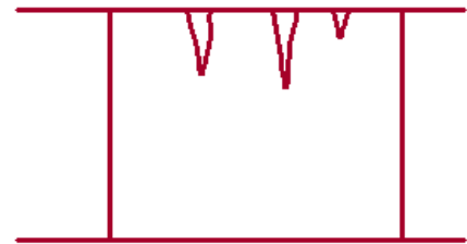
FALLA DE MUROM SIN VIGA SOLERA
