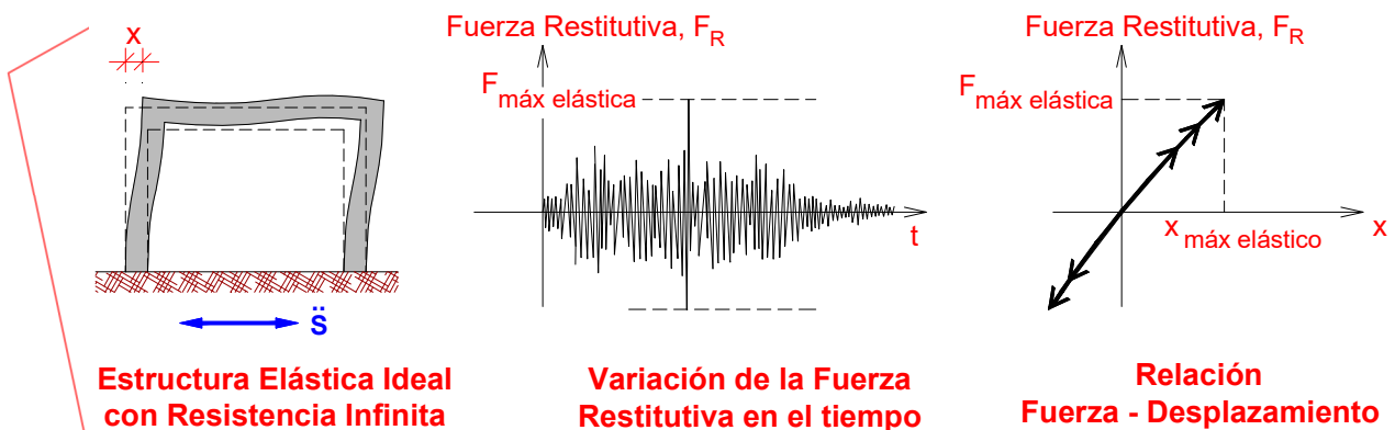
Figura 6.14 Respuesta sísmica de una estructura ideal con resistencia infinita
