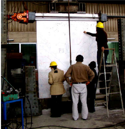
Figura 6.3 Ensayo incremental en un muro de concreto armado
