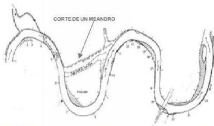
Figura N° 2.10 Planta característica de un río a meandros (Leopold).
