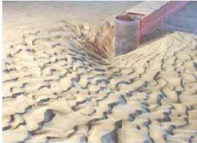
Figura N° 10.13 Modificación del lecho fluvial en los alrededores de un estribo (José Daniel Brea y otros).
