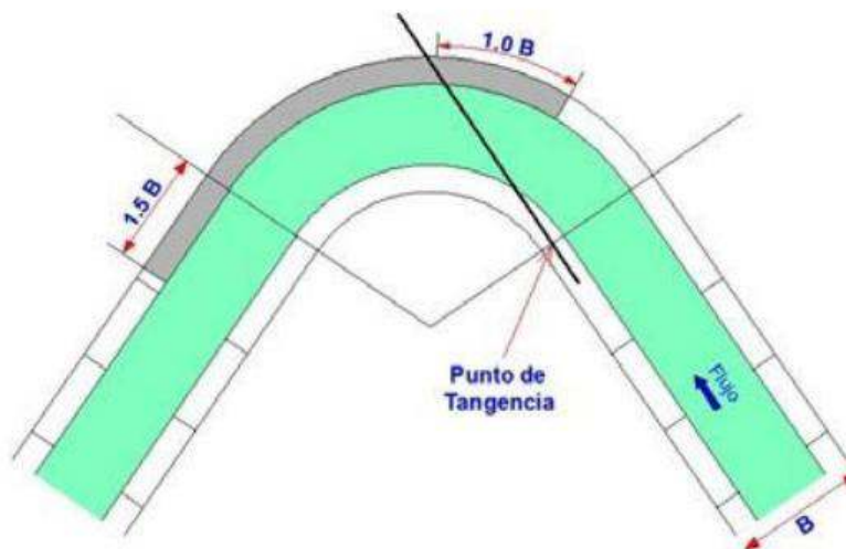
Figura N° 9.18 Recomendaciones para la protección de la margen exterior de un tramo en curva (Cuerpo de Ingenieros de los Estados Unidos). USACE, 1981
