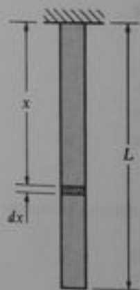
Fig. 2-40 Ejemplo 2. Barra que cuelga bajo su propio peso
