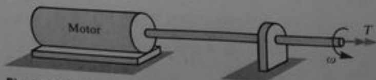
Fig. 3-19 Flecha o barra eje que transmite un par T a una velocidad angular \omega
