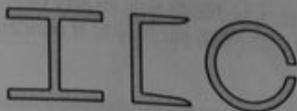
Fig. 3-33 Secciones abiertas de pared delgada
