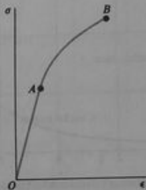
Fig. 1-13 Diagrama esfuerzo-deformación característico de un material frágil
