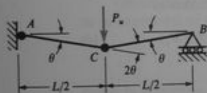
Fig. 10-13 Aplicación del principio de desplazamientos virtuales
