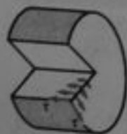
Fig. 3-3 Esfuerzos cortantes longitudinales en una barra circular
