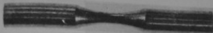
Figura 14-9 Probeta lisa utilizada para determinar el comportamiento hasta la iniciación de la fatiga (la longitud de la probeta es aproximadamente 5 pul).
