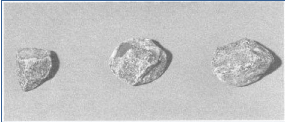
Figura: 4 Partículas Fracturadas (Bordes redondeados, Superficie Rugosa)
