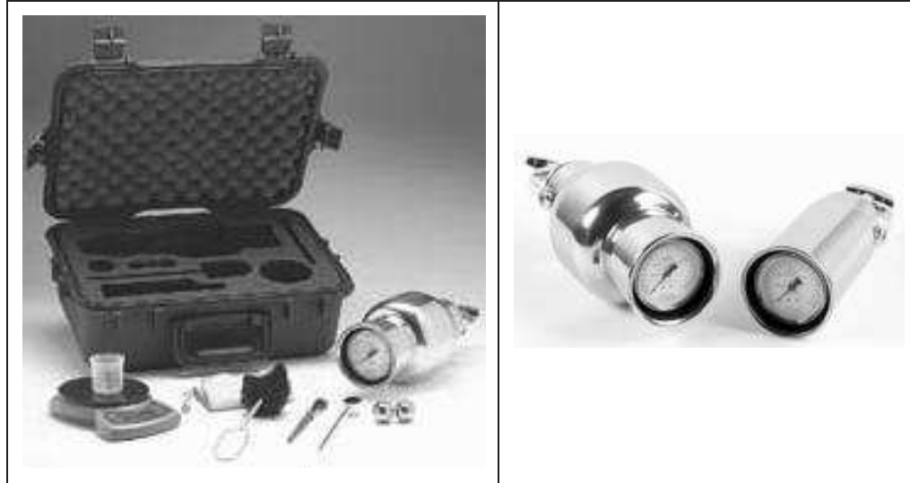
Figura 1: Medidor de humedad de gas a presión con Carburo de Calcio
