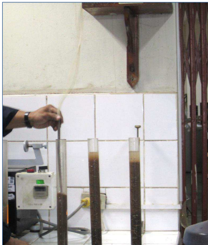
Figura 6 – Tubo irrigador y ensamblaje de sifón
