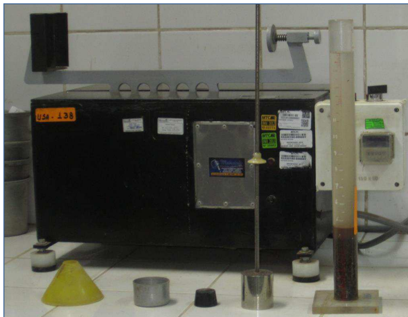
Figura 2 – Agitador mecánico y sus componentes
