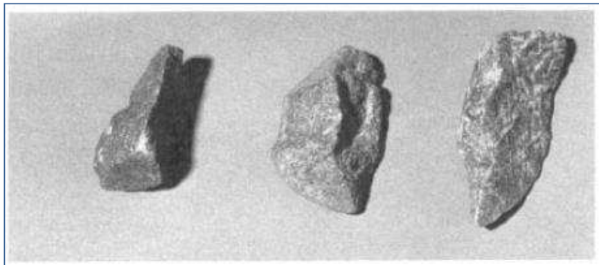
Figura: 2 Partículas Fracturadas (Bordes Agudos, Superficies Rugosas)
