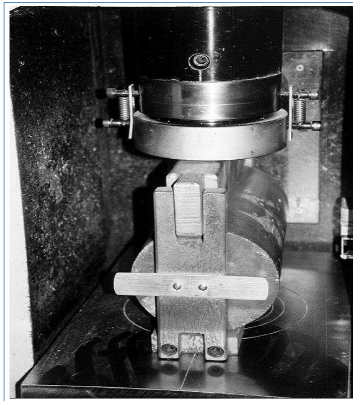
Figura 3. Cilindro colocado para ensayo de tensión indirecta
