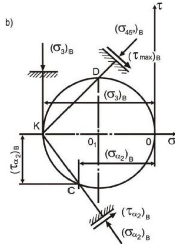
El círculo de Mohr para el punto B, se muestra en la figura b) . Este caso es análogo al punto A, con la única diferencia que  $(\sigma_3)_B < 0$  , debiendo ubicarse el punto K a la izquierda de O.
