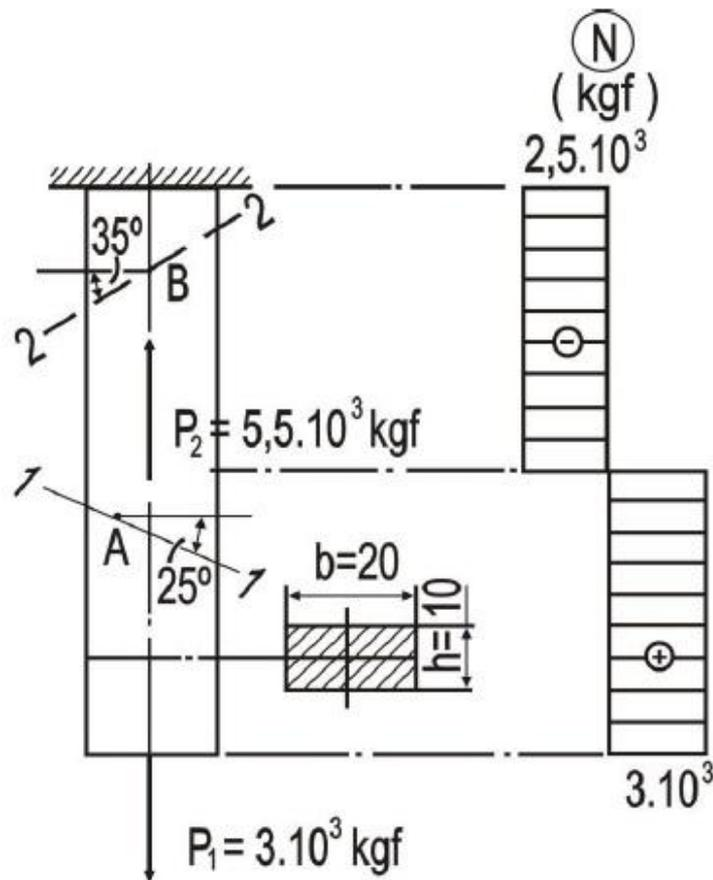
Correspondientemente, el esfuerzo normal en la sección transversal indicada es esfuerzo principal para el punto A.
