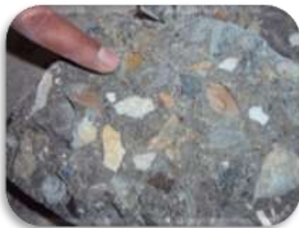
Fig. N° 12: Se observa q fallo la pasta y en menor proporción el agregado
