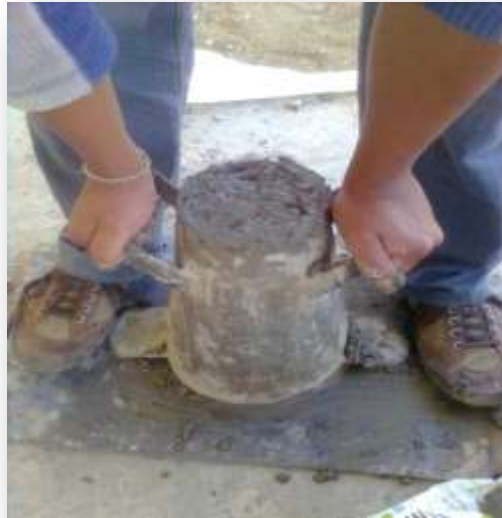
Fig. N° 15-16: Enrazando la mezcla en el cono y desmoldando la mezcla.
