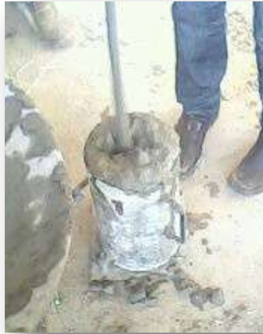
Fig. N° 19-20-21: las tres etapas de compactación en agregar el concreto a los moldes de acero (25 golpes por etapa)
