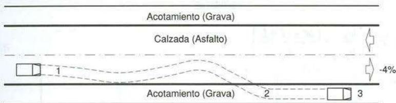
Figura 4.10 Vehículo en un frenado de emergencia
