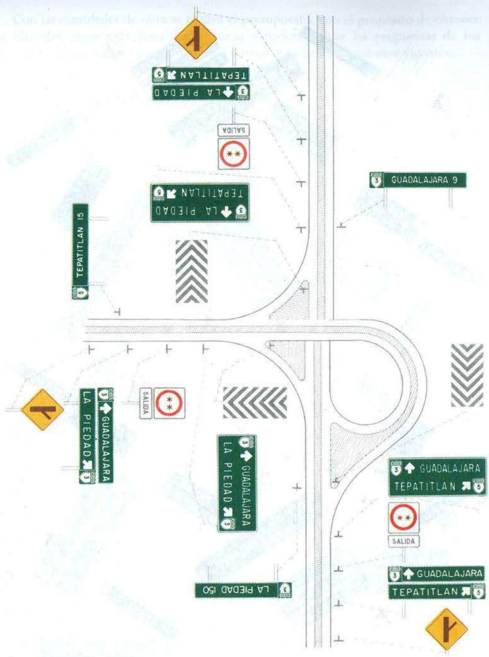
Figura 7.19 Proyecto de señalamiento en un distribuidor tipo trompeta
